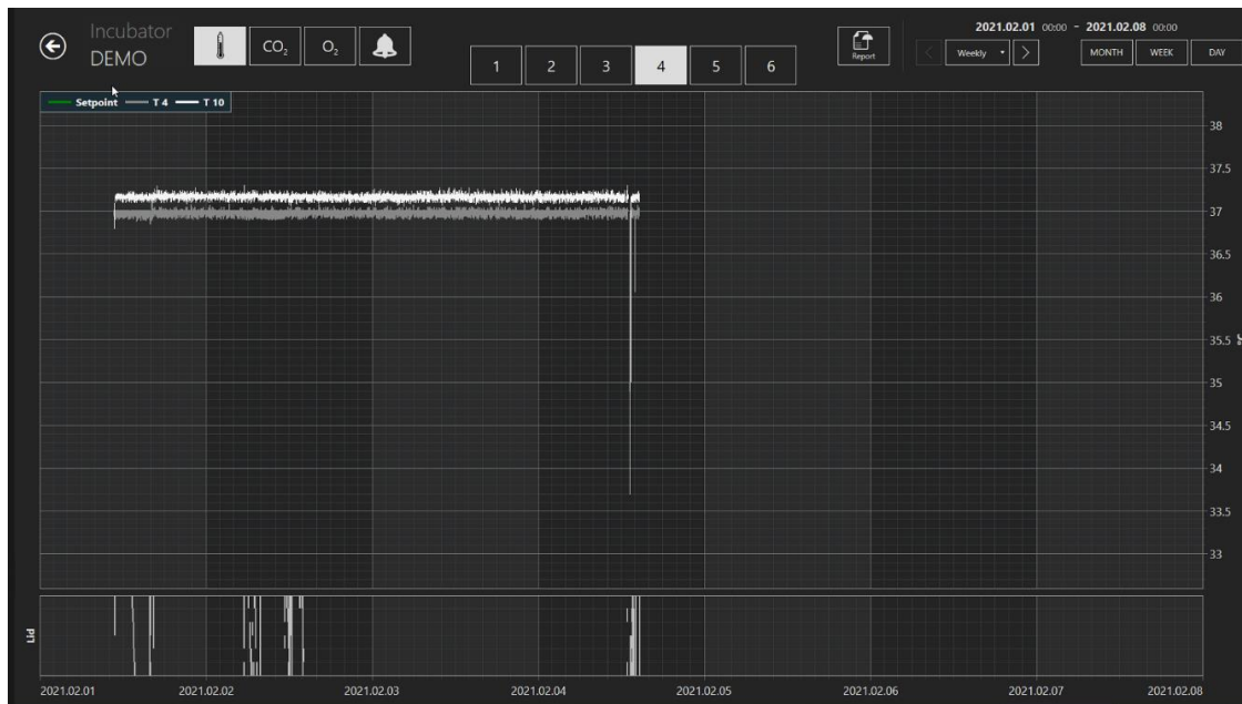
Abbildung 7.123 Ansicht des Temperatur-Inkubationsdaten-Protokolls des „DEMO“-Inkubators
